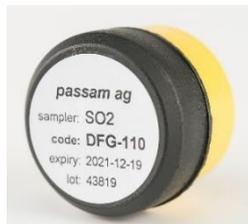
Der Sammler arbeitet nach dem Prinzip der passiven Diffusion: SO<sub>2</sub>-Moleküle dringen in das Gehäuse ein und werden vom absorbierenden Medium (Kaliumkarbonat) aufgenommen. Die Probennahme erfolgt autark über 1 bis 4 Wochen. Ein Schutzfilter reduziert Umwelteinflüsse wie Wind und ermöglicht eine präzise Messung.
